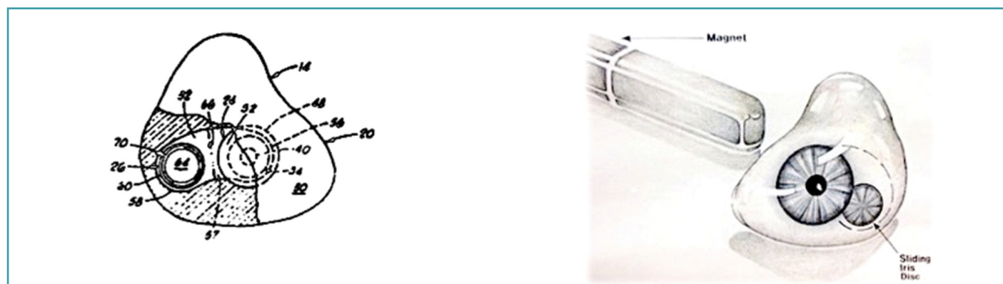
Figura 6. Prótesis ocular con dilatación pupilar magnética. Compuesta por un mecanismo alojado en el interior de la prótesis. El paciente desliza un imán sobre la superficie de la prótesis modificando el diámetro pupilar en función de las condiciones lumínicas. La prótesis necesita un espesor mínimo de 5 mm para poder alojar en su interior el mecanismo.
